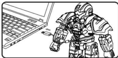
Подсоедините USB-провод одним концом к отверстию на корпусе робота, а другим концом – к USB-порту.
